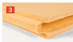
3 GUTEX Multitherm waterbestendige houtvezelisolatie plaat achter een geventileerde gevelafwerking. Ook als isolatieplaat bovenop de dak constructie of als bijkomende isolatie aan de binnenzijde van een dak.
